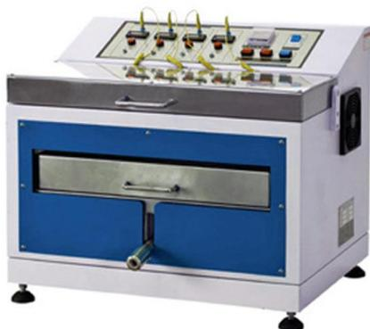
La máquina utilizaba una bola de acero estándar colocada en el interior del cuero, y de esta manera para hacer pruebas a prueba de agua y torsión.
