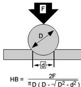
El número de dureza Brinell es una función de la fuerza de prueba dividida por el área de superficie curva de la sangría. La sangría se considera esférica con un radio igual a la mitad del diámetro de la bola. El promedio de las dos diagonales se usa en la fórmula anterior para calcular la dureza Brinell.
