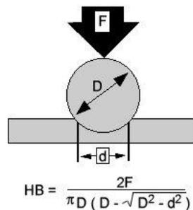
El número de dureza Brinell es una función de la fuerza de prueba dividida por el área de superficie curva de la sangría. La sangría se considera esférica con un radio igual a la mitad del diámetro de la bola. El promedio de las dos diagonales se usa en la fórmula anterior para calcular la dureza Brinell.
